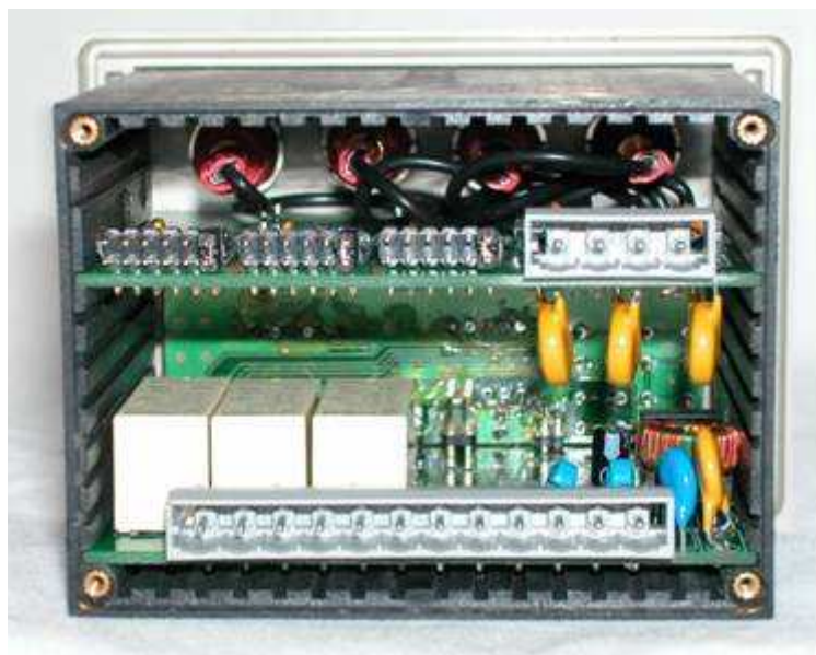
Rys.6. Widok na zworki po zdjęciu pokrywy tylnej miernika MN
