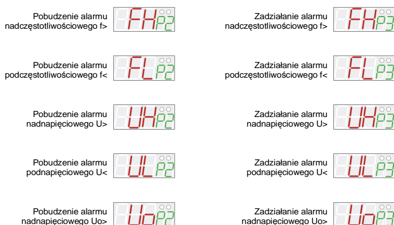
Rys. 13. Sygnalizacja pobudzenia i zadziałania poszczególnych alarmów.
