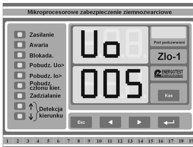
Rys. 7. Widok panelu czołowego zabezpieczenia Zlo-1.
