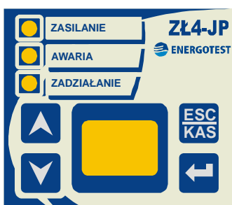
Rys. 3 Płyta czołowa jednostki polowej ZŁ-4 JP.
