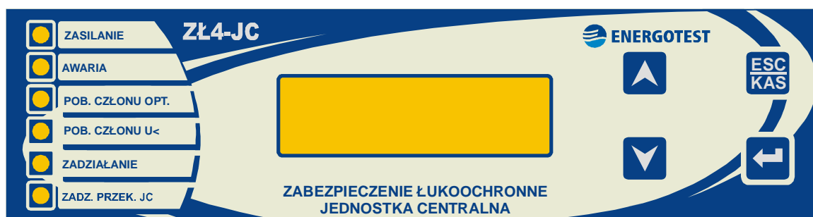
Rys. 2 Płyta czołowa jednostki centralnej ZŁ-4 JC.
